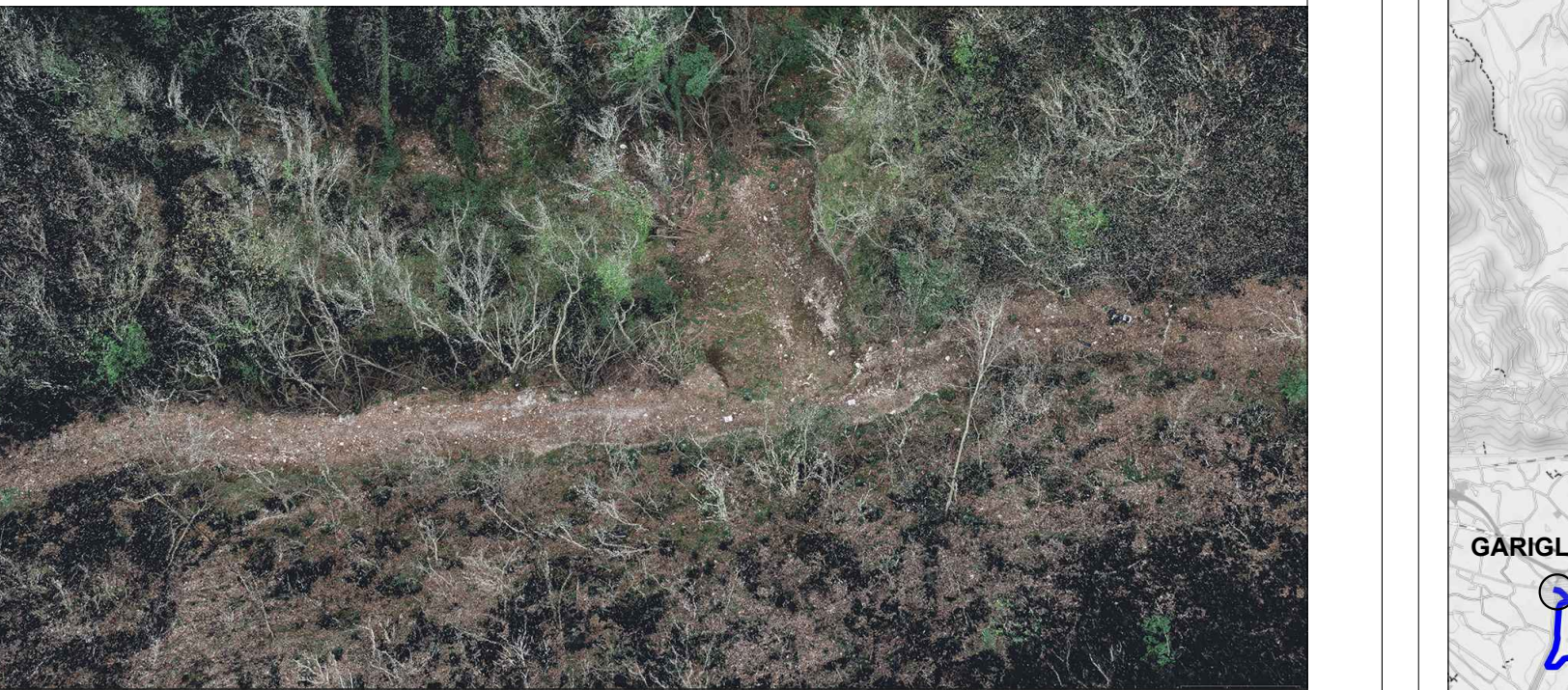
RELIEVO INTEGRATO TLS (TERRESTRIAL LASER SCANNER) E SAPR (SISTEMA AEROMOBILE A PILOTAGGIO REMOTO) DI UN SEGMENTO DELLA VIA FRANCIGENA
